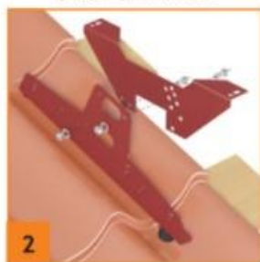
Монтаж кронштейна регулирующего
